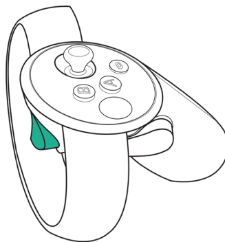
Figure 2 — La gâchette du contrôleur permet d'interagir avec les menus et les outils.
